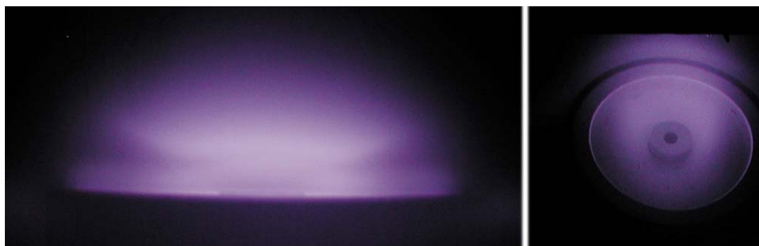
Рис. 4. Характерный вид разряда в присутствии магнитного поля (сбоку и сверху; воздух, p = 10^{-2} Торр в Ar, I = 60 мА)
